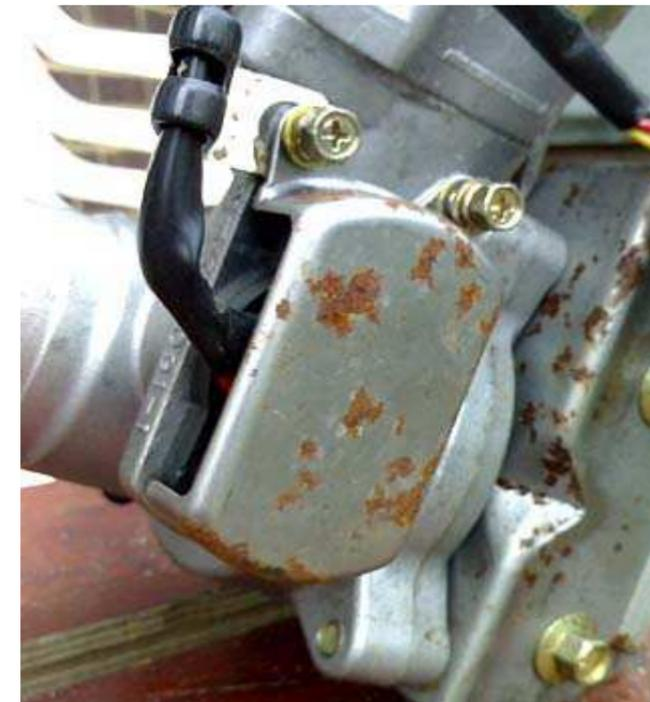
Mit einem Cutter-Messer den Kleber von den Stellschlitzen entfernen (mit A gekennzeichnet). Es ist nicht nötig alles zu entfernen, nur ein wenig dass man zum Verschieben braucht.
