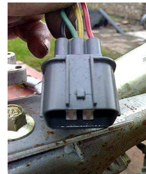
6 Volt Batterie zwischen 0V und 5V (Schwarz und Rot, Polarität egal) verbinden, und das Voltmeter zwischen Sensor A und B (grün und gelb, polarität egal) verbinden.
