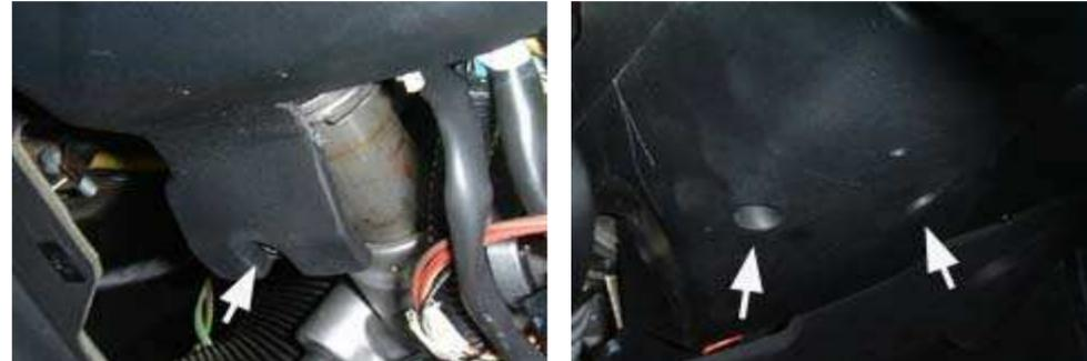
Um Zugriff auf den Sensor zu erhalten, löst man den Sicherungskasten und schiebt ihn leicht nach rechts. Es gibt zwei Schrauben, die linke (Pfeil A), die andere auf der rechten Seite mit dem Pfeil B
