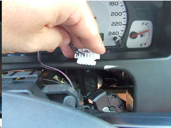
Weisser Stecker ausgesteckt mit orig. Kabelbelegung (Stecker um 180° gedreht!)
