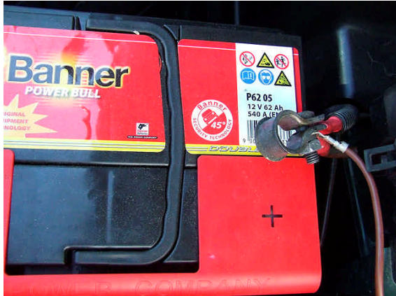
Batterie von Bordnetz trennen
