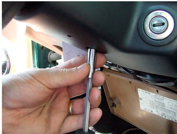
Position der Schrauben unterhalb des Lenkrades
