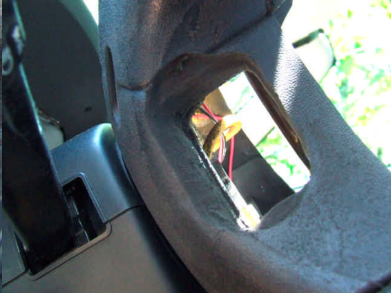
Mittels Dremel verfeinerte LFB-Aussparung
