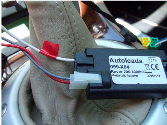
Das weisse Kabel führt direkt zum Steuergerät
