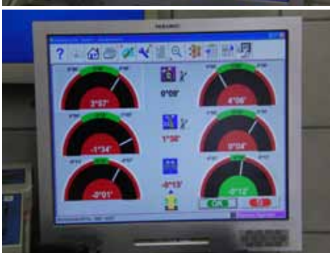
Bild 13: Achsvermessung einrichten
