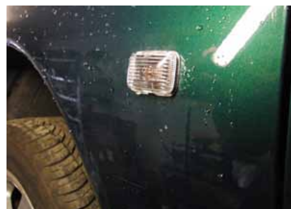
Bild 6: Anrostungen Seitenblinker
