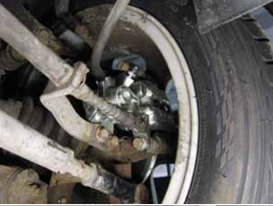
Bild 20: Bremssattel hinten rechts (erneuert)
