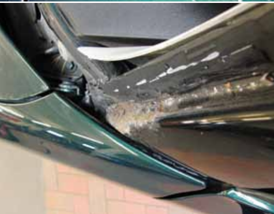
Bild 7, 8, 9: Anrostungen am Scheibenrahmen
