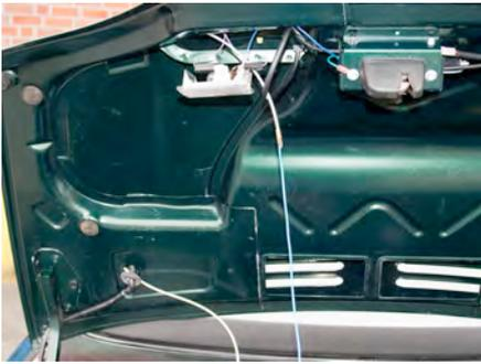
Nun heißt es, den Öffnerantrieb mit dem langen blauen Kabel an das Kabel des Zigarettenanzünders anzuschließen. Dabei ist eine Einziehhilfe für Kabelkanäle aus dem Baumarkt hilfreich. Die habe ich sowohl für das Durchführen von der Kofferraumlampe als auch von der Hutablage benutzt.
