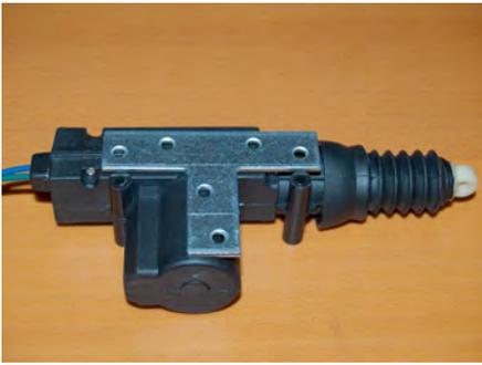
Hier sieht man deutlich den Winkel aus dem Baumarkt, dessen Bohrungen fast perfekt zu den Montagepunkten des Antriebs passen. Die mussten nur wenig aufgefild werden:
