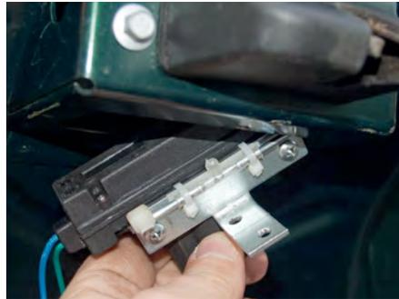
Ist der Punkt gefunden, werden zwei Bohrpunkte markiert und gebohrt.
