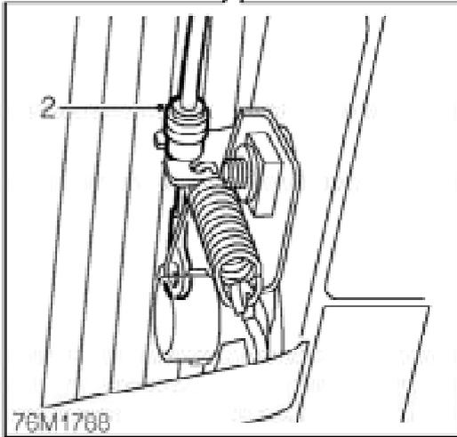
2. Zug von Frontklappenschließblech lösen.
