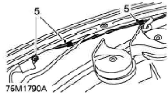
5. Schraube zur Befestigung des Masseverteilers am Innenkotflügel lockern und Zug von 2 Innenkotflügelclips lösen.
