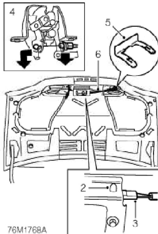
2. Mehrfachstecker von Heckklappenschlossfallenhalter lösen.
