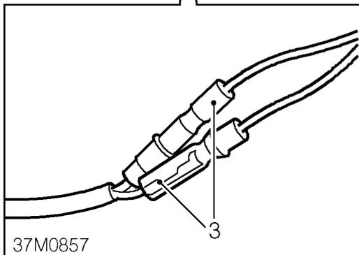
3. Steckverbindungen an Rückfahrlichtschalter abnehmen.
