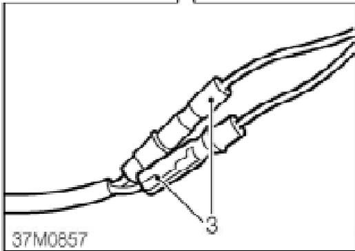
3. Steckverbindungen an Rückfahrlichtschalter abnehmen.
