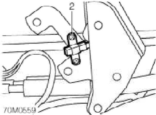
2. 2 Schrauben zur Befestigung des Schalters am Hebel entfernen und Schalter aufnehmen.
